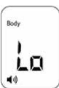
في وضع قياس درجة حرارة الجسم، سوف تعرض شاشة مقياس الحرارة رسالة "LO" إذا كانت درجة حرارة العنصر التي يتم قياسها أقل من 0 درجة مئوية (32 درجة فهرنهايت). في وضع قياس درجة حرارة الغرفة، سوف تعرض شاشة مقياس الحرارة رسالة "LO" إذا كانت درجة حرارة البيئة المحيطة التي يتم قياسها أقل من 0 درجة مئوية (32 درجة فهرنهايت). تظهر هذه الرسالة لأسباب مختلفة. يرجى مراجعة قائمة المشكلات التالية:
